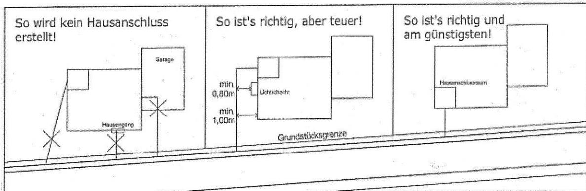
Die Hausanschlussleitung auf dem Grundstück (außerhalb und innerhalb des Gebäudes) muss leicht zugänglich sein. Die Trasse darf weder überbaut noch mit aufwendigen Sträuchern und Bäumen überpflanzt werden. Auch darf sie keine ungewöhnlich hohe Überdeckung (aber mindestens 1,00 m) aufweisen.
